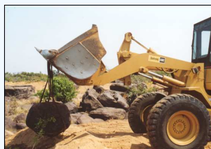
Fig. 4: Extração de bloco com auxílio de máquina.
